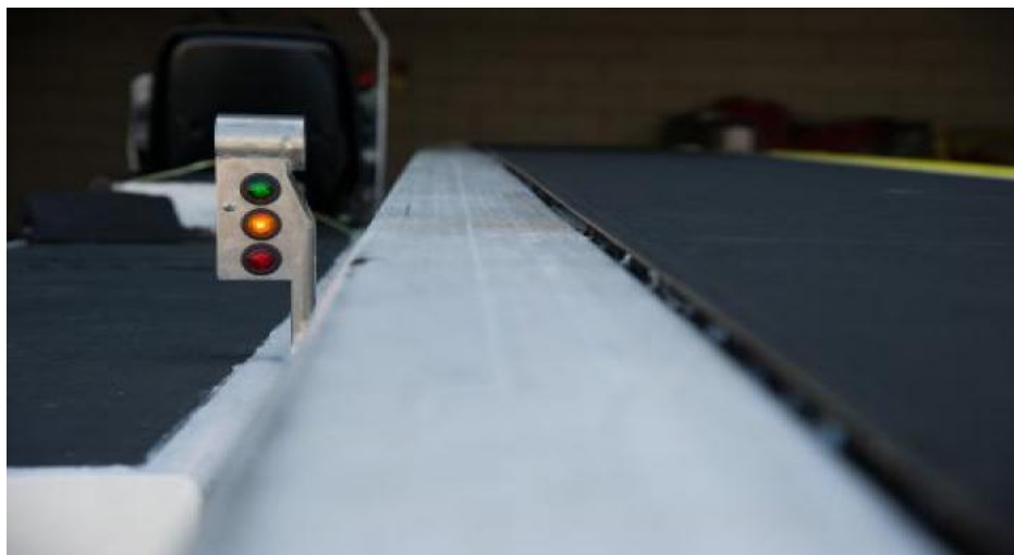
Figura 75. Banda transportadora equipada con sensores y semáforo
