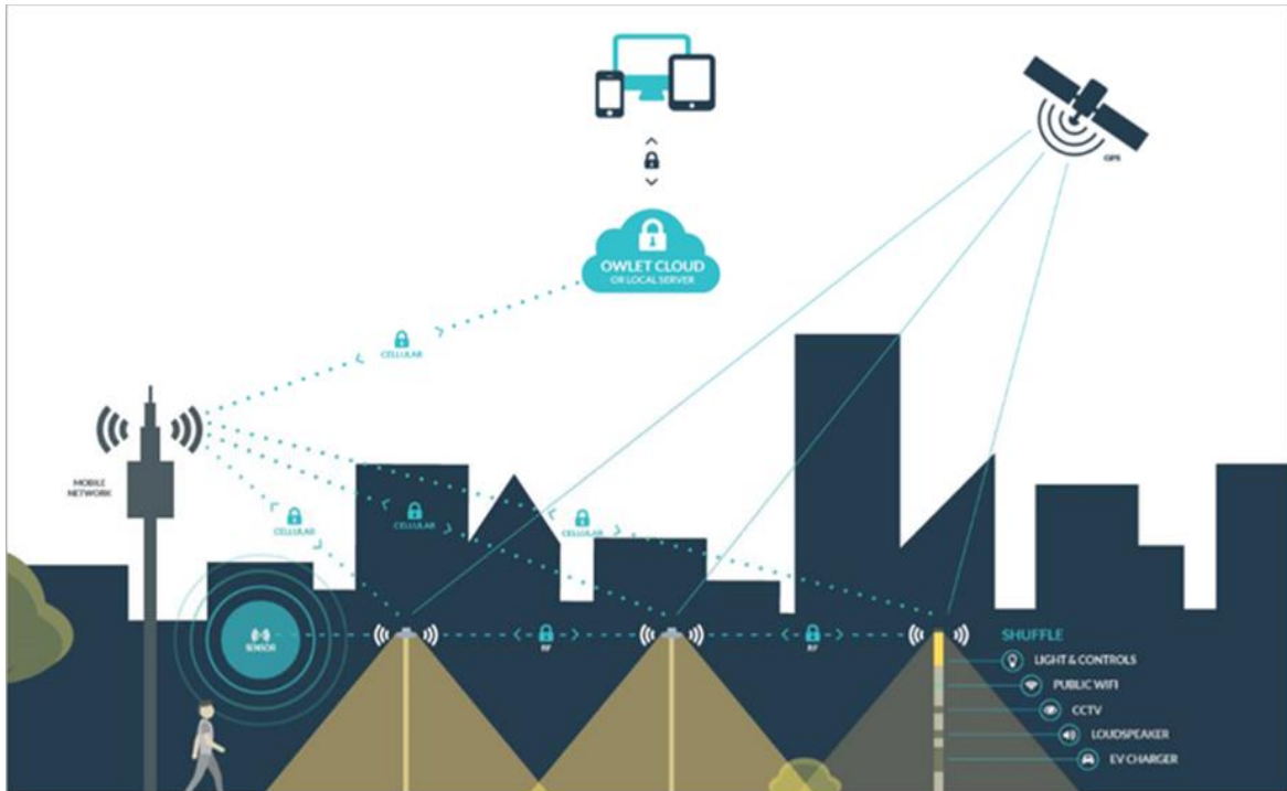
Figura 31. Funcionamiento del sistema de alumbrado público conectado
